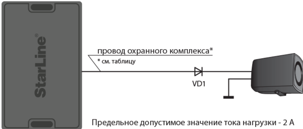
Схема подключения автомобильной сирены
