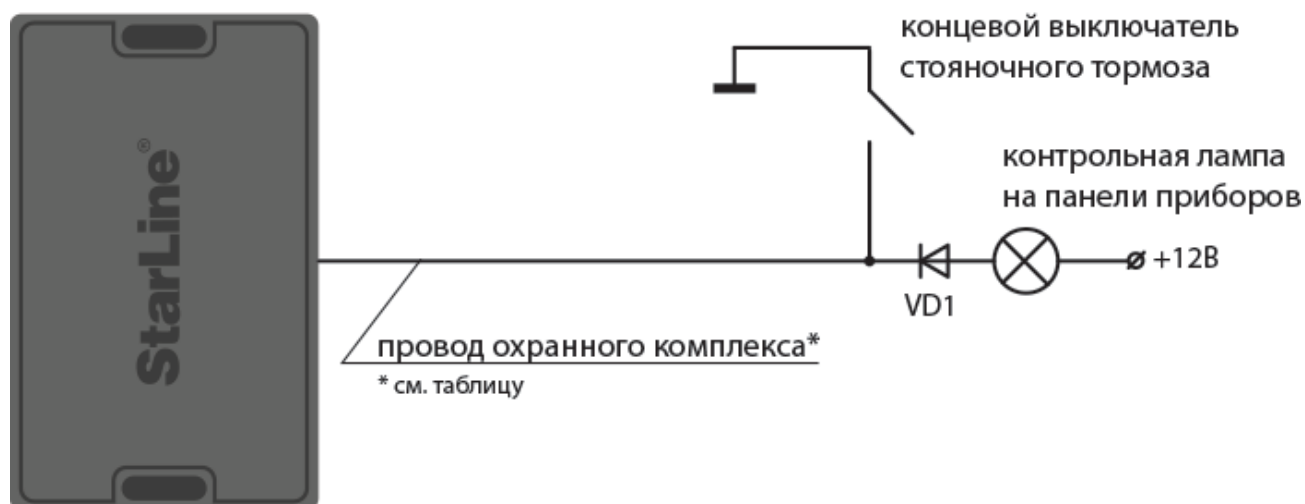
Схема подключения стояночного тормоза
