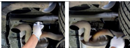
**ШАГ 2.** Выпрямите закладную, держа её за шпильку. Совместите отверстия в закладной и в лонжероне. Совместите кронштейн боковой с отверстиями в лонжероне и закрепите кронштейн болтом М10х1,25х40, через шайбу 10 и гроверную шайбу 10. А так же гайкой М10 с шайбой 10 и гроверной шайбой 10.
