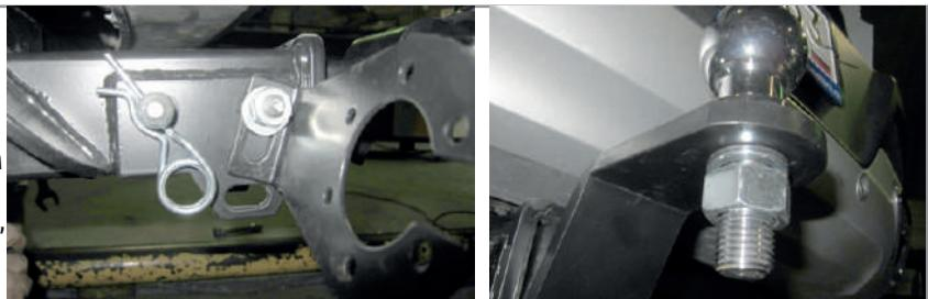
**ШАГ 6.** Установите фиксирующий болт M10x20 снизу, он используется для исключения технологических люфтов съемного шара и только в ненагруженном состоянии!
