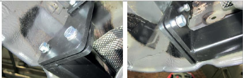
**ШАГ 5.** Установите кронштейн розетки и закрепите его с помощью болта M10, шайбы 10 гроверной и шайбы 10. Затяните все соединения, отрегулировав положение ТСУ. Установите съемный шар в сборе и закрепите его пальцем гнутым гальванизированным со шплинтом пружинным игольчатым. Затяните шар ключом на 38 мм. Установите задний бампер, согласно руководства по ремонту автомобиля.
