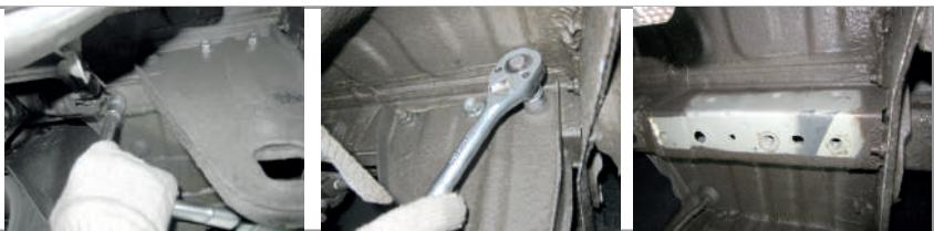
**ШАГ 2.** Установите кронштейн левый, совместив отверстия кронштейна с отверстиями в лонжероне автомобиля и соедините их с закладными пластинами с помощью болтов M10x1,25x40 через шайбы 10 и шайбы 10 гроверные.
