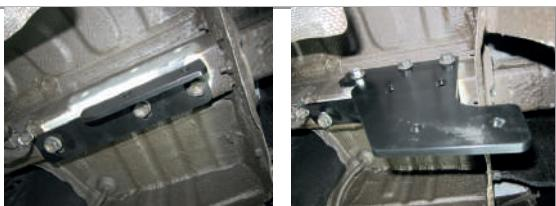
**ШАГ 4.** Установите балку ТСУ, совместив отверстия в боковых кронштейнах с отверстиями балки ТСУ, и соедините их с помощью болтов M10x40 через шайбы и шайбы 10 гроверные.
