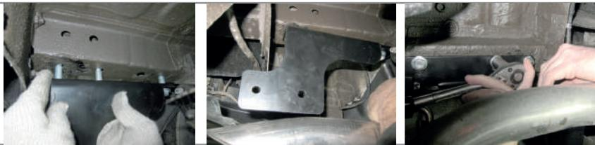
**ШАГ 3.** Установите уголок, совместив отверстия уголка с отверстиями в нижней части правого лонжерона автомобиля и соедините их с помощью болтов крепления проушины. Аналогично установите кронштейн правый и соедините его с отверстиями на боковой части лонжерона автомобиля и с отверстиями в уголке с помощью двух болтов M10x40 , гайками M10, через шайбы 10 и гроверы 10.
