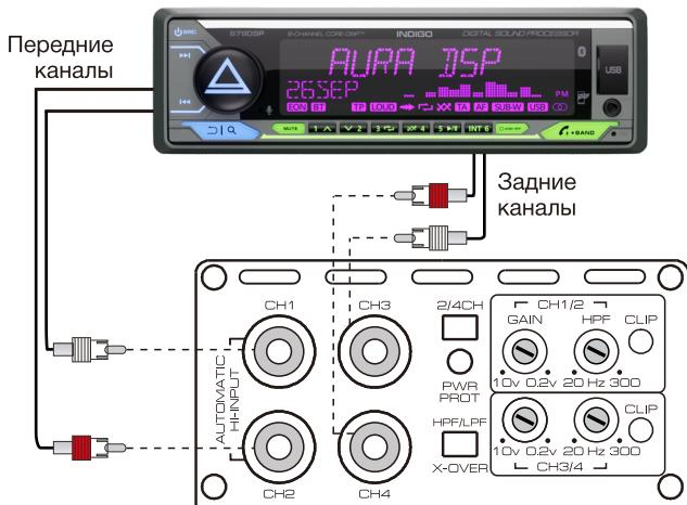
**ВАЖНО!** Усилители AurA VENOM ULTRA поддерживают прямое подключение выходов динамиков к RCA-входам усилителя без использования дополнительных Hi/Low конвертеров. Для подключения используйте разъемы-адаптеры, входящие в комплект. Входная чувствительность (GAIN) должна быть установлена в минимально левое положение (10V).
