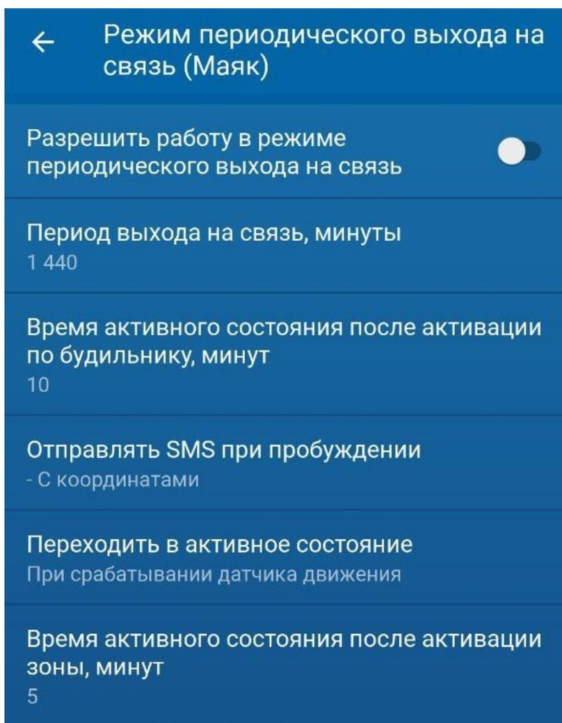
При включении "Разрешить работу в режиме периодического выхода на связь" устройство отсчитывает "Время активного состояния, минут" и переходит в пассивное (отключает GSM, GPS). В этом состоянии события сохраняются в черный ящик, контролируются зоны (зажигание, датчик движения). Находясь в пассивном состоянии устройство отсчитывает
