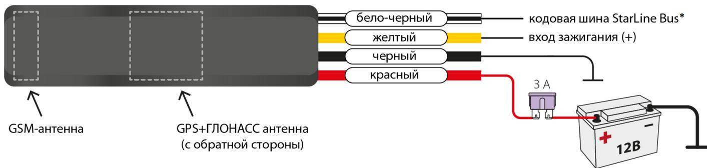
\*Для устройств с серийным номером M18M S211... и выше начиная с версии ПО 2.30.3 добавлена возможность работы канала SLBUS в режиме универсального выхода. Максимальная допустимая нагрузка 200 мА (-). Управление производится SMS-командами: "К+" - включить канал, "К-" - отключить.
