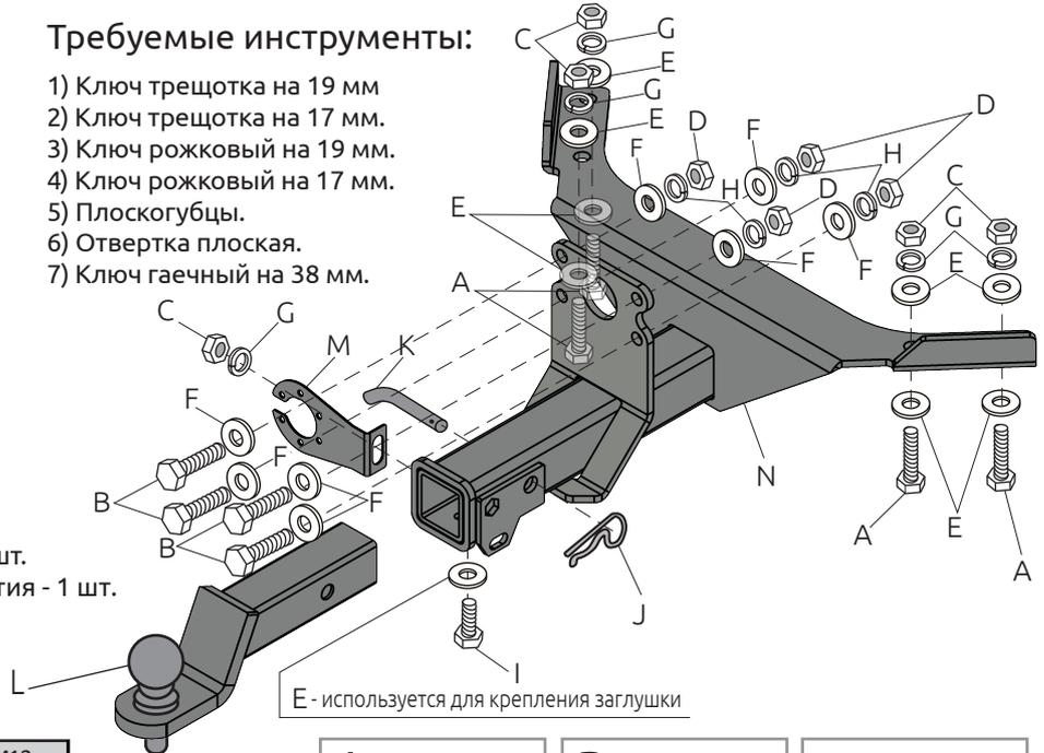
Table with 3 columns: Диаметр резьбы, М10, М12; Момент затяжки Нм, 47, 80
