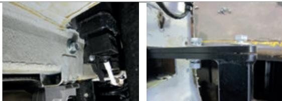
**ШАГ 3.** Закрепите каждую закладную пластину в ближнем отверстии с помощью болта М10х1,25х40 через шайбу 10 гроверную и шайбу 10. Затяните все резьбовые соединения. **Перед установкой бампера** наклейте на нижнюю юбку бампера шаблон по центру бампера и аккуратно вырежьте по контуру шаблона отверстие в бампере.
