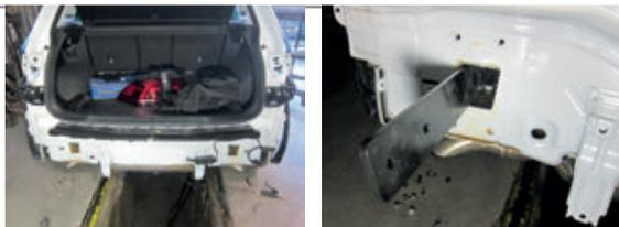
**ШАГ 2.** Закрепите каждую закладную пластину с помощью болта М10х1,25х40 и шайб 10 в дальнем отверстии закладной пластины. Установите балку ТСУ, совместив его отверстия с отверстиями в закладных пластинах и соедините их с помощью болтов М10х1,25х40, через шайбы 10 гроверные и шайбы 10, гайками М10х1,25.
