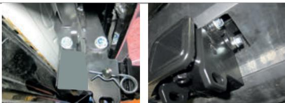
**ШАГ 5.** Установите съёмный шар в сборе и закрепите его пальцем гнутым гальванизированным со шплинтом пружинным игольчатый. Затяните шар ключом на 38 мм. Установите фиксирующий болт М10х20 снизу, **он используется для исключения технологических люфтов съёмного шара и только в ненагруженном состоянии! Перед сцепкой болт демонтировать!**
