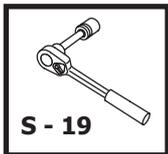
**Затянуть все резьбовые соединения (M12=81 Nm)
