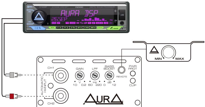
**ВАЖНО!** Усилители AurA VENOM ULTRA поддерживают прямое подключение выходов динамиков к RCA-входам усилителя без использования дополнительных Hi/Low конвертеров. Для подключения используйте разъемы-адаптеры, входящие в комплект. Входная чувствительность (GAIN) должна быть установлена в минимальное (левое) положение (10V).
