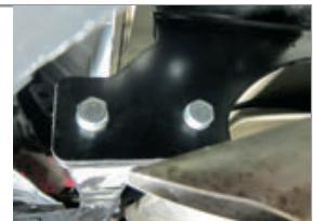
**ШАГ 5.** Установите съёмный шар в сборе и закрепите его пальцем гнутым со шплинтом. Зафиксируйте съёмный шар болтом M10x20 снизу, он используется для исключения технологических люфтов съемного шара и только в ненагруженном состоянии! Перед сцепкой болт демонтировать!
