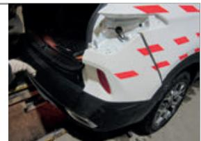
**ШАГ 4.** Установите кронштейн розетки и закрепите его на шпильке с помощью гайки M10 через шайбу 10 увеличенную и шайбу 10 гроверную. Закрепите балку ТСУ на боковых с помощью болтов M12x1,25x40 через шайбы с помощью гаек.
