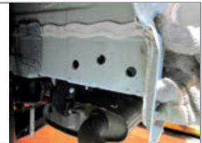
**ШАГ 3.** Установите кронштейны, совместив отверстия в кронштейнах и в лонжеронах, и с закладными шпильками M8.
