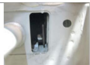
**ШАГ 2.** Аналогичным образом установите закладные шпильки M8 и пластины с левой стороны автомобиля. Убедитесь, что отверстия в закладных пластинах соосны с отверстиями в лонжеронах автомобиля.
