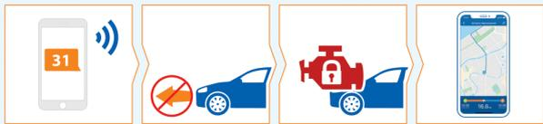
**Внимание!** При утере метки или разряде элемента питания на телефон придет SMS-оповещение и при включении зажигания двигатель будет заблокирован. Для продолжения поездки переведите трекер в сервисный режим (SMS-команда «51»). Помните, что в сервисном режиме все охранные функции отключены!
