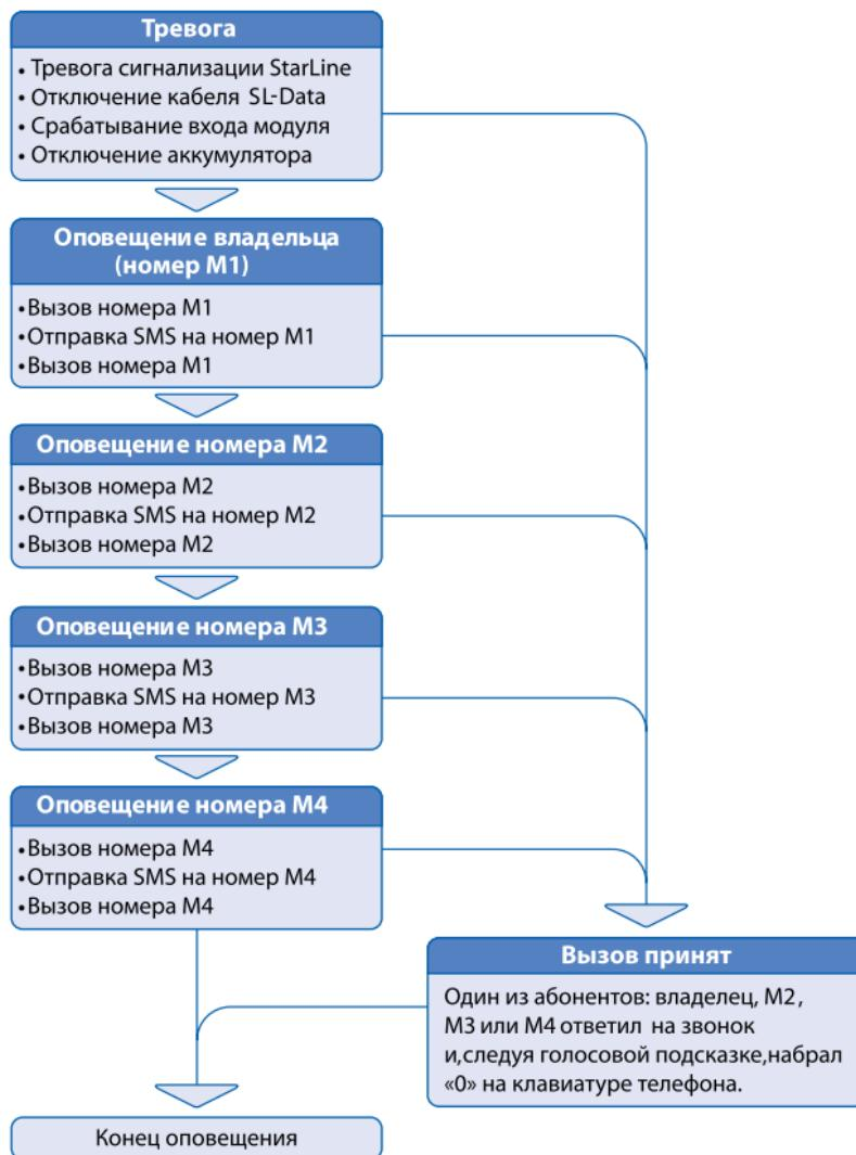
В случае срабатывания автосигнализации StarLine, самого модуля StarLine M32/M22 или другой автосигнализации, подключенной к модулю StarLine M32/M22 на записанные в память номера, рассылаются оповещения о тревоге с указанием причины срабатывания. В случае получения звонка о тревоге сигнализации, владелец, следя голосовой подсказке, должен нажать клавишу «0» на своем телефоне. Это нажатие подтверждает прием голосового сообщения о тревоге и отменяет последующие попытки дозвона и отправку SMS.
