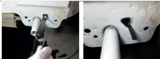
**ШАГ 3.** Установите кронштейн нижний левый, совместив отверстия в кронштейне с отверстиями в лонжероне автомобиля, и, соединив всё при помощи болта M12x40, через шайбу 12 и шайбу 12 гроверную. А так же с помощью болта M10x25, через шайбу 10 и шайбу 10 гроверную. Аналогично установите правый кронштейн и закрепите его с помощью болта M12x40 и шайб 12.
