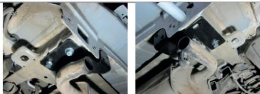
**ШАГ 4.** Установите проставки, левую и правую и закрепите их на кузове автомобиля с помощью болтов M8x25 и M8x40, шайб 8 увеличенных и шайб 8 гроверных.
