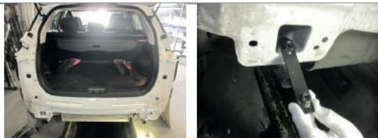
**ШАГ 2.** Установите закладную пластину с одной гайкой в маленькое технологическое отверстие в правой нижней части кузова автомобиля, как показано на фотографии.
