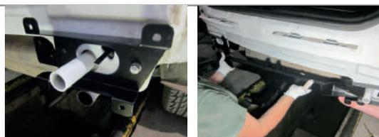
**ШАГ 5.** Затяните все резьбовые соединения. Прикрутите к проставкам усилитель бампера, установите обратно бампер и задние фонари.
