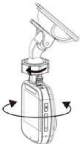
3. Затем затяните пластиковую гайку, чтобы убедиться, что устройство надежно зафиксировано на месте.
