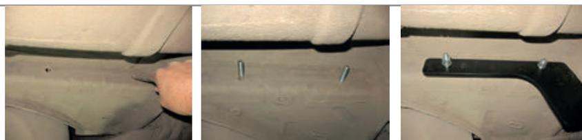
**ШАГ 4.** Установите балку ТСУ и соедините его с боковыми кронштейнами с помощью метизов из комплекта поставки. Затяните крепёжные элементы.
