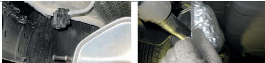
**ШАГ 3.** С помощью отвертки найдите скрытые в лонжеронах отверстия. Проденьте болты М10х90 с надетыми на них шайбами и втулками в отверстия через багажник автомобиля. Установите кронштейны **гибом внутрь автомобиля** и закрепите их.
