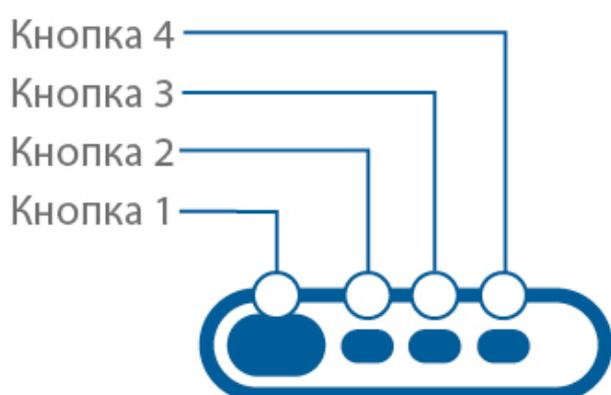
Нумерация кнопок дополнительного брелока:
