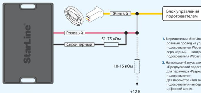
1. В приложении «StarLine Мастер» запрограммируйте розовый провод на управление предпусковым подогревателем Webasto по цифровой шине, серо-черный — контроль запуска предпускового подогревателя Webasto по цифровой шине.
