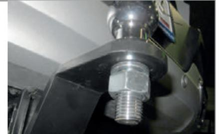
**ШАГ 6.** Установите фиксирующий болт М10х20 снизу, он используется для исключения технологических люфтов съёмного шара и только в ненагруженном состоянии! Перед сцепкой болт демонтировать! Шар в сборе может устанавливаться по вылету в два положения. Установка завершена.
