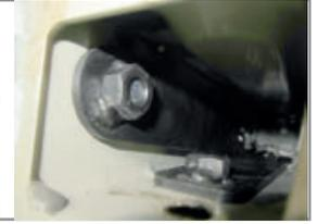
**ШАГ 2.** Установите кронштейн правый, совместив отверстия кронштейна с отверстиями в лонжероне автомобиля и соедините их с закладными пластинами с помощью болтов М10х40 через шайбы и шайбы 10 гроверные. Аналогично установите уголок (поз.1).
