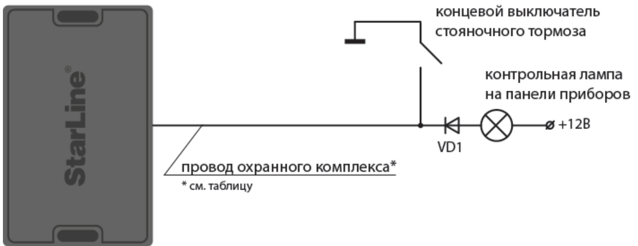
Рис. 4. Схема подключения стояночного тормоза
