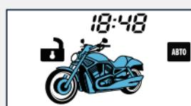
Через 30 секунд после выключения зажигания автоматически включится режим охраны.
