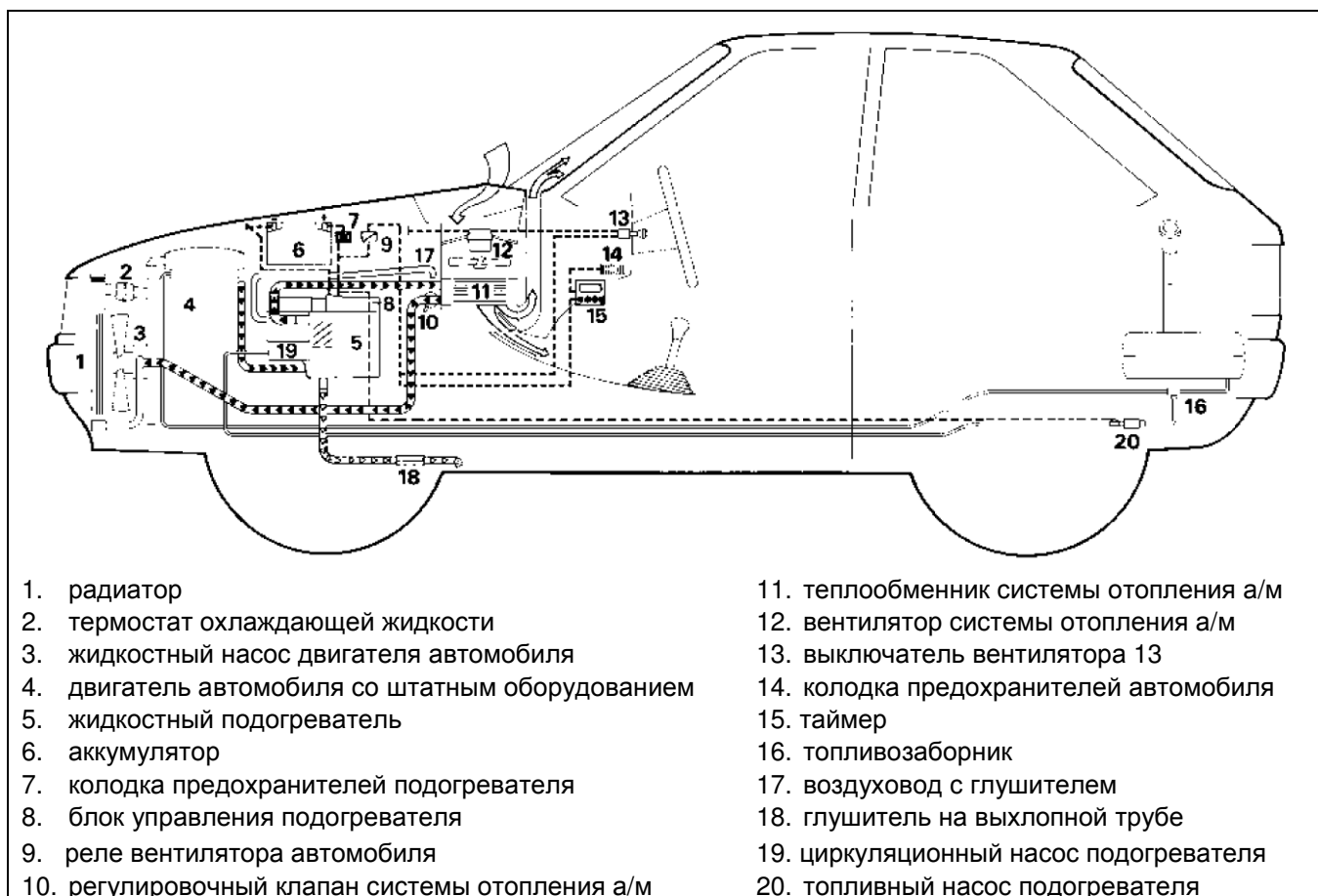
Рис. 3 Пример установки подогревателя в легковом автомобиле
