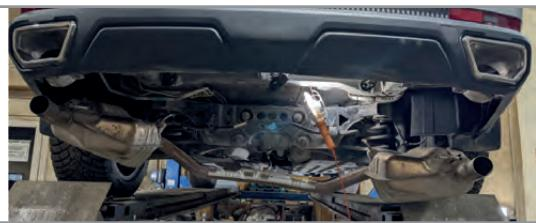
**ШАГ 2.** Установите кронштейны боковые на места крепления усилителя заднего бампера. Вставьте закладные пластины в ниши лонжеронов через отверстия А, как показано на схеме. Расположите основания, согласно схеме, наживите винтами M10x20. Обратите внимание на различия отверстий крепления а и б для левого и правого основания.
