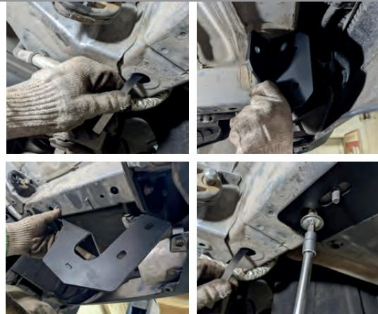
**ШАГ 3.** Максимально ослабьте винты, соединяющие закладные пластины и основания. Приснимите со шпилек кронштейны левый и правый. Просуньте под бампер балку ТСУ. Совместите отверстия в балке с отверстиями на кронштейнах и на основаниях, прилегающим к кронштейнам. Соедините детали болтами M10x1,25x40 через шайбы 10 и гроверные шайбы 10, и гайку M10 для нижнего отверстия.
