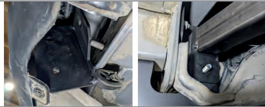
**ШАГ 4.** Поместите кронштейны на штатные шпильки. Закрепите их штатными гайками с фланцем. Отрегулируйте положение ТСУ и затяните все соединения. Установите глушители и термоэкраны глушителей на место.
