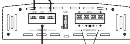
Блок акустических терминалов для подключения акустики;
