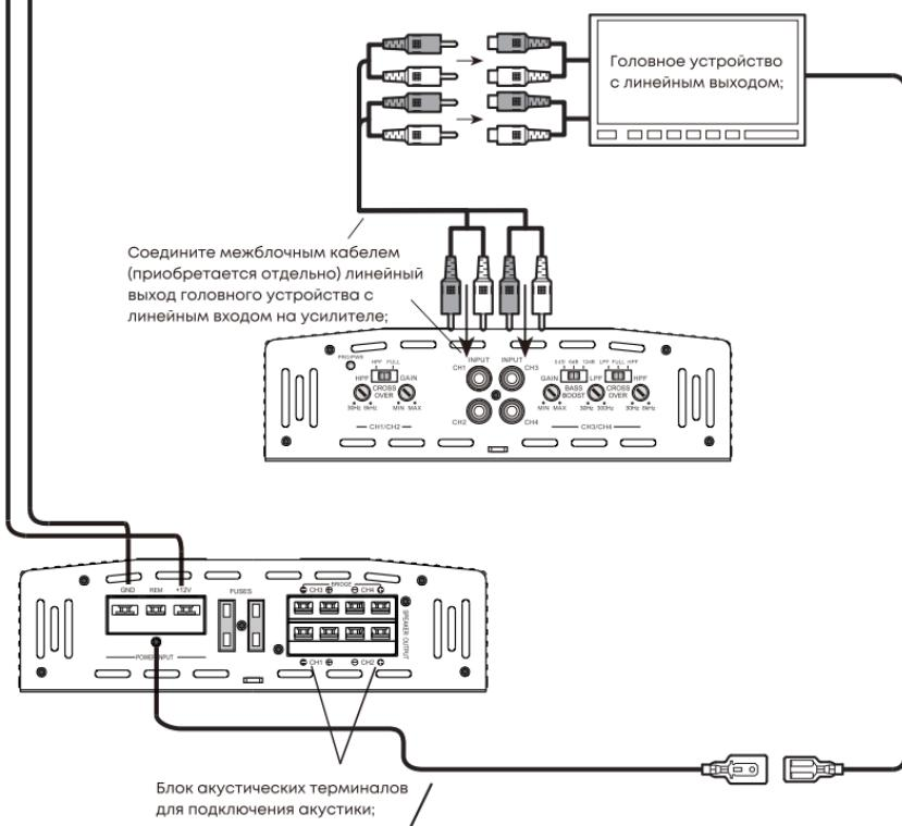
Провод управления включения усилителя. Соедините эту клемму с соответствующим проводом на головном устройстве. Также клемму можно подключить к резистору автомобильной антенны. Еще один метод – подключить провод REMOTE на зажигание автомобиля;
