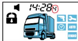
Для выключения турботаймера одновременно и коротко нажмите кнопки 3 и 4 основного брелка:
