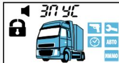
затем - индикация работающего двигателя, режима включенной охраны и оставшегося времени прогрева двигателя (r10, r20 или r30):
