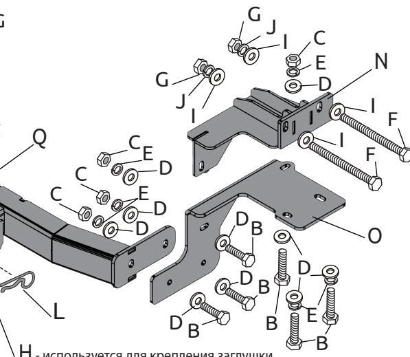
Класс прочности метизов: Болт - 8.8, Гайка - 8
