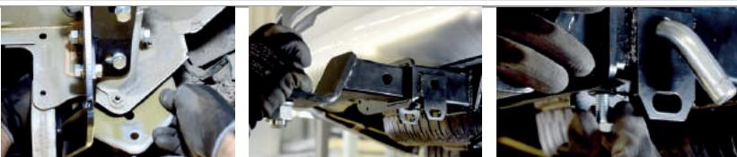
**ШАГ 5.** Установите фиксирующий болт M10x20 снизу, он используется для исключения технологических люфтов съемного шара и только в ненагруженном состоянии! Перед сцепкой болт демонтировать!
