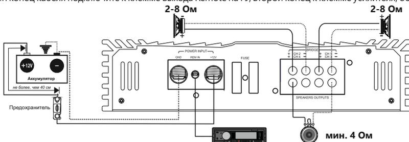
**Внимание!!! Минимально допустимое сопротивление при поканальном включении - 2 Ом на каждый из каналов усилителя. Для усилителей MLA-4080, MLA-4120 рабочее напряжение составляет 10-15 В.**
