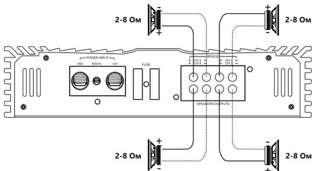
**Внимание!!! Минимально допустимое сопротивление при поканальном включении - 2 Ом на каждый из каналов усилителя. Для усилителей MLA-4080, MLA-4120 рабочее напряжение составляет 10-15 В.**
