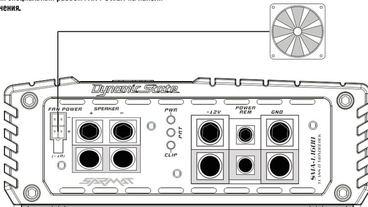
\*\*\* В случае эксплуатации усилителя в жарком климате или при его сильных нагревах, рекомендуем подключить внешний вентилятор для обдува вентиляционных отверстий и ребер радиатора. Некоторые модели усилителей опционально оборудованы терминалом для автоматического включения питания вентилятора.
