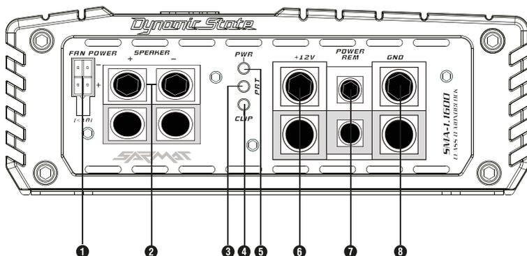
**1. FAN** - Разъём для подключения дополнительно-го вентилятора охлаждения.
