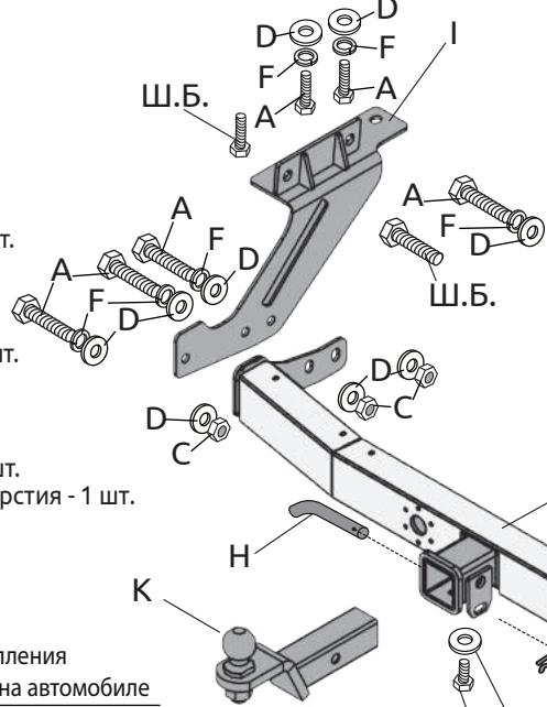
**Ш.Б.** - Штатные болты крепления кронштейна, установленные на автомобиле
