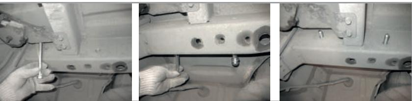
**ШАГ 2.** Установите боковые кронштейны и закрепите их с помощью гаек M12 через шайбы 12 с двух сторон лонжерона и шайбы 12 гроверные. Кронштейны не затягивайте.
