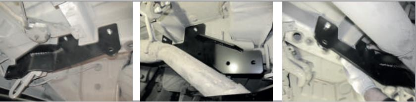
**ШАГ 3.** Установите балку ТСУ, совместив отверстия в балке ТСУ с отверстиями в боковых кронштейнах и соедините всё с помощью болтов M10x1,25x40, гаек M10x1,25, шайб 10 и шайб 10 гроверных.
