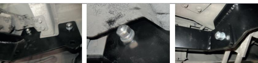
**ШАГ 4.** Для установки угловых кронштейнов, вставьте в технологические отверстия лонжеронов закладные пластины с гайками M12. Установите угловые кронштейны и соедините всё с помощью метизов из комплекта поставки, согласно схемы.
