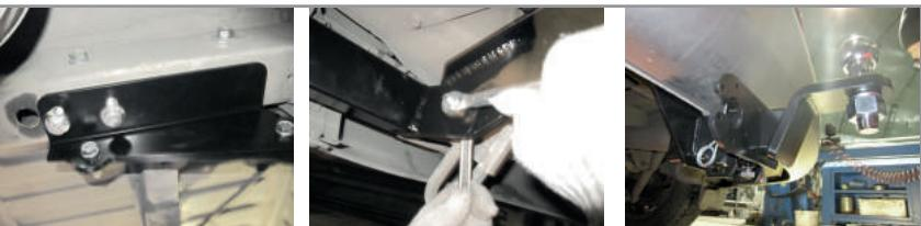
**ШАГ 6.** Установите фиксирующий болт M10x20 снизу, он используется для исключения технологических люфтов съемного шара и только в ненагруженном состоянии!
