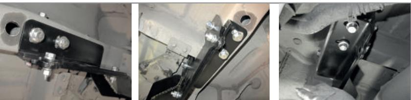
**ШАГ 5.** Затяните все соединения, отрегулировав положение ТСУ. Установите съёмный шар в сборе и закрепите его пальцем гнутым гальванизированным со шплинтом пружинным игольчатым.
