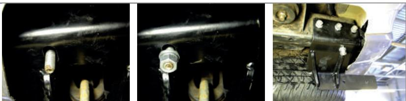
**ШАГ 4.** Для установки фаркопа совместите отверстия в балке ТСУ с резьбовыми отверстиями кронштейнов и соедините всё с помощью болтов M10, через шайбы 10 и гайки M10. Затяните все резьбовые соединения.
