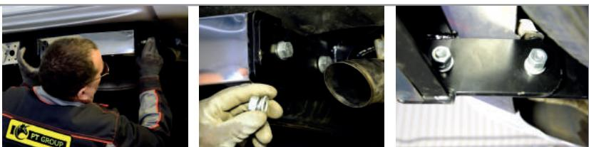
**ШАГ 5.** Установите съемный шар в сборе и закрепите его пальцем гнутым со сплинтом пружинным игольчатым. Затяните шар ключом на 38 мм. Установите фиксирующий болт M10x20 снизу, он используется для исключения технологических люфтов съемного шара и только в ненагруженном состоянии! Перед сцепкой болт демонтируйте!
