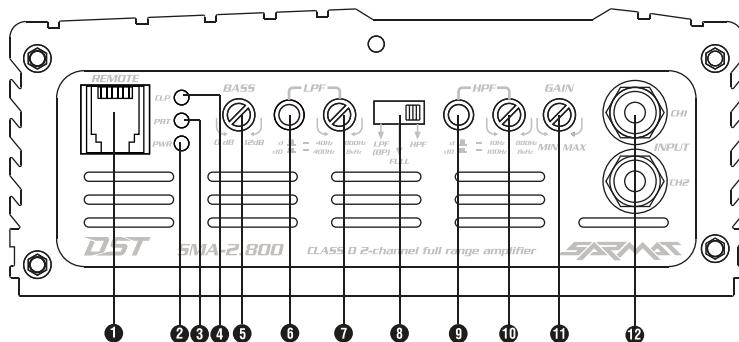
**1. REMOTE** - Разъём для подключение внешнего регулятора контроля уровня каналов.
