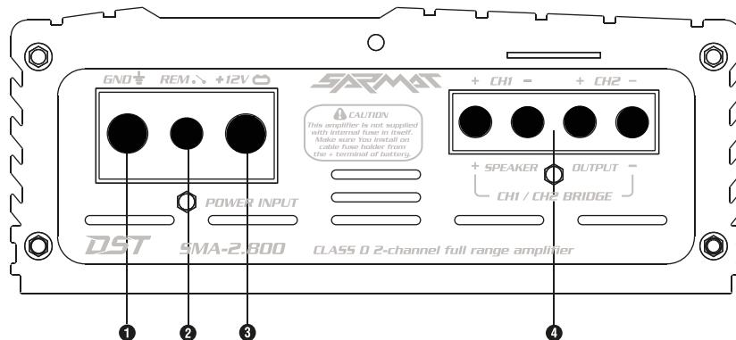
**1. GND** - Разъём питания усилителя. Для подключения минусового кабеля питания сечением до 25 мм<sup>2</sup>. Подключается в последнюю очередь.
