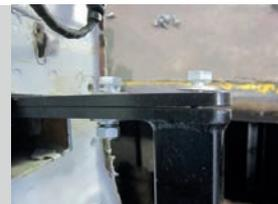
**ШАГ 3.** Закрепите каждую закладную пластину в ближнем отверстии с помощью болта М10х40х1,25 через шайбу гроверную на 10 и шайбу на 10. Затяните все резьбовые соединения. **Перед установкой бампера** наклейте на нижнюю юбку бампера шаблон по центру бампера и аккуратно вырежьте по контуру шаблона отверстие в бампере.
