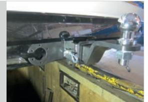
Тип соединения: шаровый; Диаметр сцепного шара: 50 мм.; Масса комплекта ТСУ SKQ991101: 19 кг.
