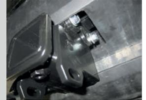
**ШАГ 5.** Установите съемный шар в сборе и зафиксируйте его с помощью пальца гнутого гальванизированного и шплинта пружинного. Затяните шар с помощью ключа на 38 мм. Вкрутите стопорный винт М10х20 снизу. Установка завершена.
