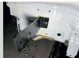
**ШАГ 2.** Закрепите каждую закладную пластину с помощью болта М10х40х1,25 и шайб на 10 в дальнем отверстии закладной пластины. Установите кронштейн центральный, совместив его отверстия с отверстиями в закладных пластинах и соедините их с помощью болтов М10х40х1,25, через шайбы гроверные на 10 и шайбы на 10, гайками М10х1,25.
