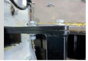
**ШАГ 3.** Закрепите каждую закладную пластину в ближнем отверстии с помощью болта М10х40х1,25 через шайбу гроверную на 10 и шайбу на 10. Затяните все резьбовые соединения. **Перед установкой бампера** наклейте на нижнюю юбку бампера шаблон по центру бампера и аккуратно вырежьте по контуру шаблона отверстие в бампере.
