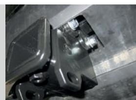
**ШАГ 5.** Установите съемный шар в сборе и зафиксируйте его с помощью пальца гнутого гальванизированного и шплинта пружинного. Затяните шар с помощью ключа на 38 мм. Вкрутите стопорный винт М10х20 снизу. Установка завершена.
