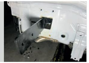
**ШАГ 2.** Закрепите каждую закладную пластину с помощью болта М10х40х1,25 и шайб на 10 в дальнем отверстии закладной пластины. Установите кронштейн центральный, совместив его отверстия с отверстиями в закладных пластинах и соедините их с помощью болтов М10х40х1,25, через шайбы гроверные на 10 и шайбы на 10, гайками М10х1,25.
