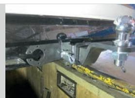
Тип соединения: шаровый; Диаметр сцепного шара: 50 мм.; Масса комплекта ТСУ SKQ991101: 19 кг.
