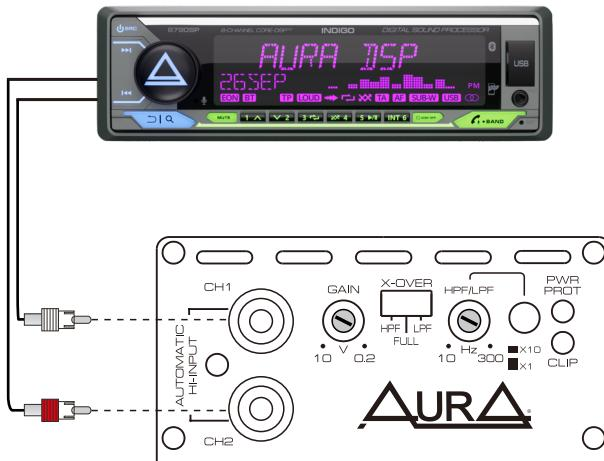
**ВАЖНО!** Усилители AurA VENOM ULTRA поддерживают прямое подключение выходов динамиков к RCA-входам усилителя без использования дополнительных Hi/Low конвертеров. Для подключения используйте разъемы-адаптеры, входящие в комплект. Входная чувствительность (GAIN) должна быть установлена в минимально левое положение (10V).
