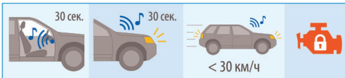
Если поддержка функции отсутствует, то после получения команды комплекс включит предупреждающие сигналы о предстоящей блокировке двигателя сиреной и световой аварийной сигнализацией в течение 10 секунд. Двигатель будет заблокирован либо спустя 3 минуты, либо после нажатия педали тормоза.
