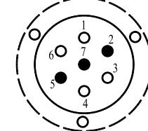
**Примечание.** На прицепах других производителей может использоваться контакт 5 для подключения габаритных огней и освещения номерного знака.
