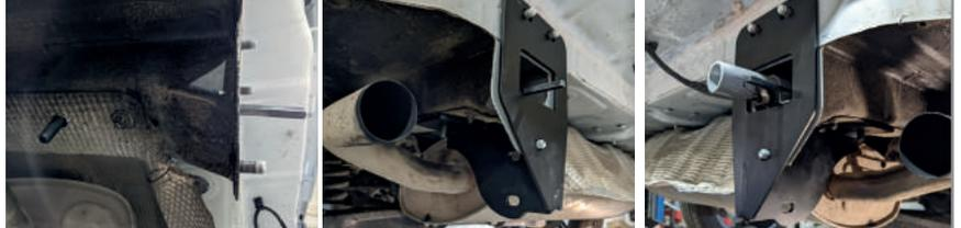
**ШАГ 5.** Зафиксируйте положение кронштейнов на шпильках закладных пластин при помощи гаек М12х1,25, шайб 12 и шайб 12 гроверных. Установите балку ТСУ на кронштейны, используя для крепления болты М10х1,25х30, шайбы 10 гроверные и шайбы 10, как показано на схеме. Затяните все соединения, отрегулировав положение ТСУ.
