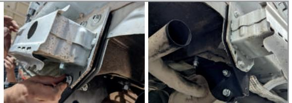
**ШАГ 7.** Установите съёмный шар в сборе и закрепите его пальцем гнутым гальванизированным со шплинтом пружинным игольчатый. Затяните шар ключом на 38 мм. Установите фиксирующий болт М10х20 снизу, **он используется для исключения технологических люфтов съёмного шара и только в ненагруженном состоянии! Перед сцепкой болт демонтировать!** Установите кронштейн розетки, как показано на схеме, используя гайку М10, шайбу 10 гроверную и шайбу 10. Установка завершена.
