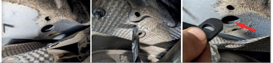
**ШАГ 3.** Установите закладную пластину с приварной шпилькой в технологическое отверстие лонжерона с правой стороны автомобиля так, чтобы шпилька прошла через отверстия в лонжероне, в проставке и в тепловом отражателе. Установите штатную гайку, крепящую отражатель к лонжерону, на место.
