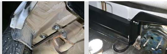
**ШАГ 3.** Установите опоры усилителя заднего бампера с помощью штатных метизов. Болты не затягивать.
