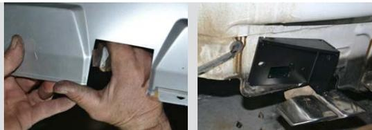
**ШАГ 2.** Закрепите кронштейны в нижней части лонжеронов болтами М10х30 через шайбы М10 и гроверные шайбы М10. Болты не затягивать. Установите центральный кронштейн (Поз. N) между боковыми кронштейнами и закрепите его с помощью болтов М8х40, через шайбы М10, гроверные шайбы М10 и гайки М10. Болты не затягивать.
